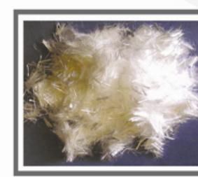
کارایی این الیاف در فوم بتن جهت جلوگیری از ترک های حاصله از بتن ، افزایش مقاومت ضربه ای ، سایشی ، بیخ نزدگی و نفوذ ناپذیری آب می باشد .
